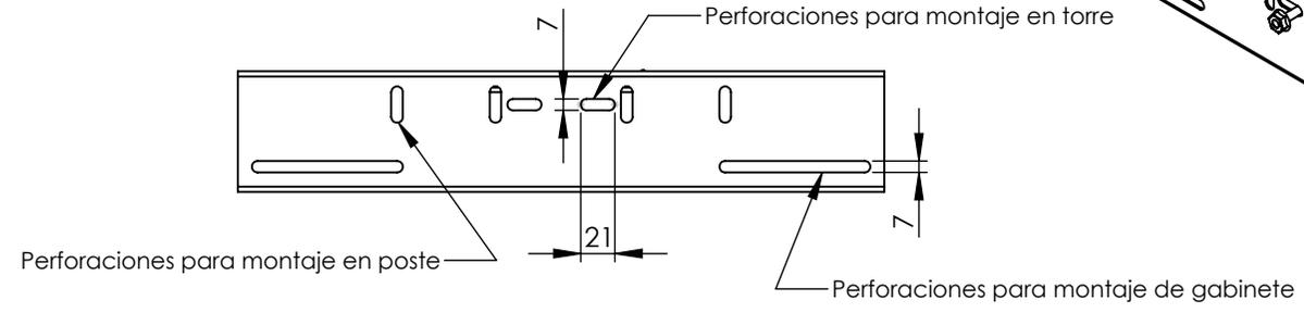
1. Montaje con compatibilidad para los modelos TXG-3040, TXG-2919S, TXG-0147, TXG-0383, TXG-0149, TXG-3545, TXG-0157, TXG-01571, TXG-4050, TXT-4050, TXG0235JK.
