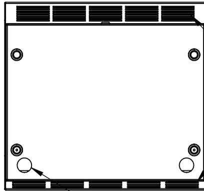
Ranuras de ventilación y extracción de aire
