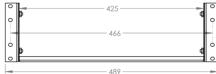
1. Fabricado en lámina de acero calibre 14.
