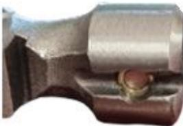
Cuenta con un sujetador metálico para clavos para evitar golpes en manos.
