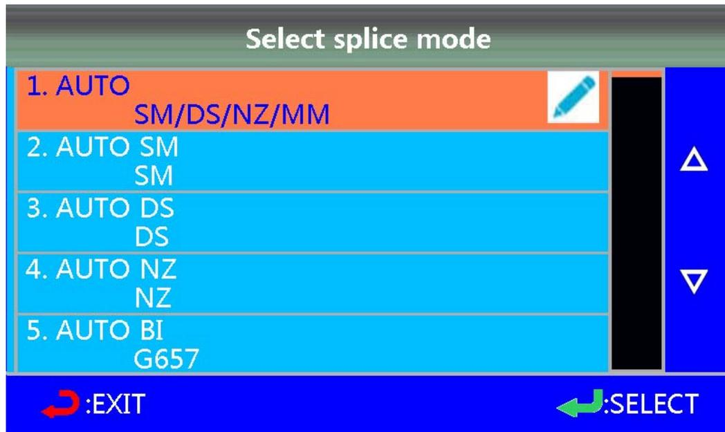
Seleccione un modo de empalme adecuado según el tipo de fibra a empalmar. Seleccionar
