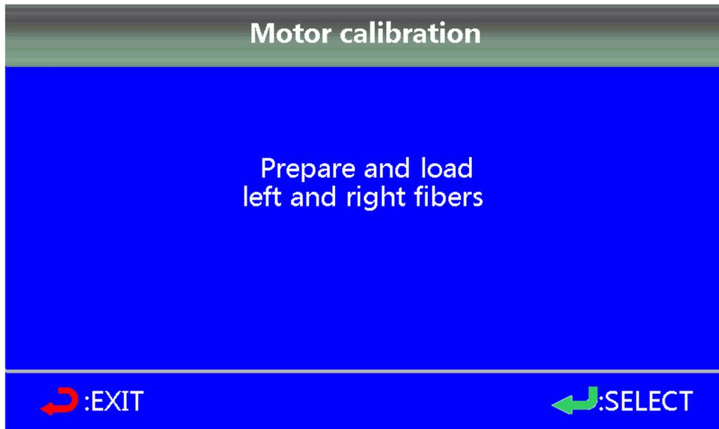
Después de la “Calibración del motor” , la posición del motor se ajustará automáticamente y se resolverán algunos errores de “Falla del motor” para reanudar el trabajo normal.
