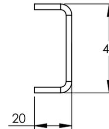
1. Fabricado en lámina de acero calibre 11 y 14, recubierta con galvanizado electrolítico.
