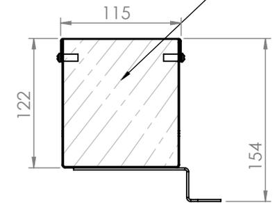
1. Fabricado en lámina de acero calibre 18 y 22.
