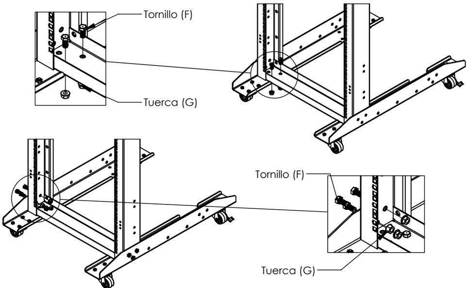
3. Coloque una el ensamble con los Soportes Triangulares (C). Una vez coloque los tornillos y tuercas, asegure el contacto entre las piezas, su posición y apriete los tornillos completamente.
