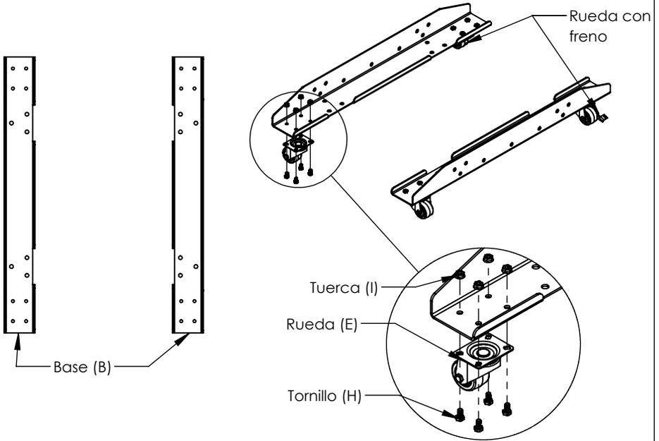
2. Coloque el cuadro rack (A) en una superficie plana, de preferencia una mesa e instale las bases (B) con las ruedas utilizando los tornillos y tuercas de 1/2" (F y G). Puede ubicar las ruedas con freno hacia al frente o atrás del rack según su preferencia. No apriete completamente los tornillos.
