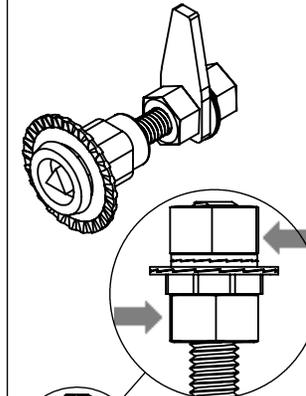
AJUSTE LAS TUERCAS Y POSICIONE LA PALETA PARA LOGRAR UN AJUSTE ADECUADO.
