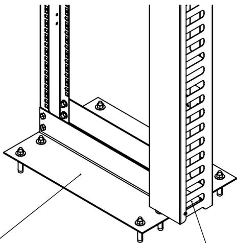
Las bases deben ser ancladas a piso para garantizar la funcionalidad del Rack
