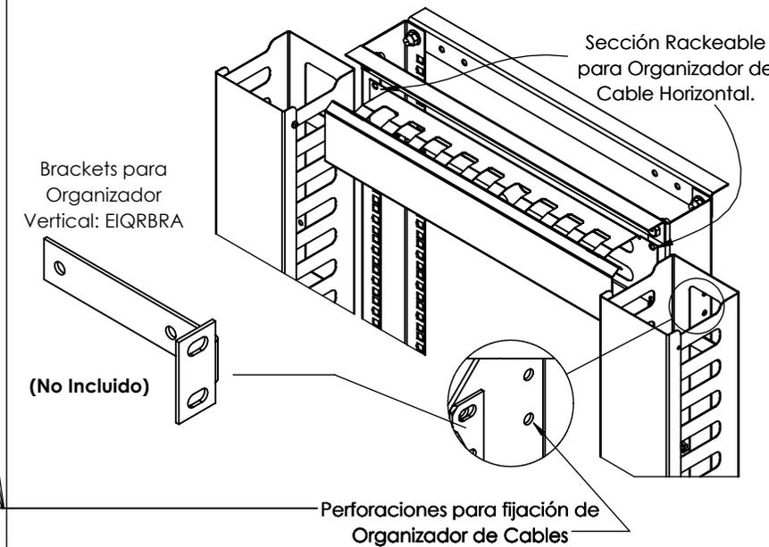
1. Fabricado con lámina de acero rolado en caliente calibre 11 y 14.
