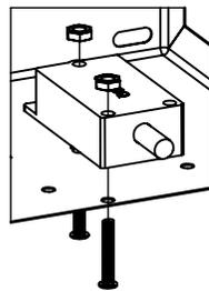
**Tamper switch (No incluido):** Cuenta con un uso sencillo de instalación. El switch se atornilla interior de la cubierta como se muestra.
