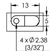
1. Fabricado en lamina negra rollada en frio calibre 22 y 26.
