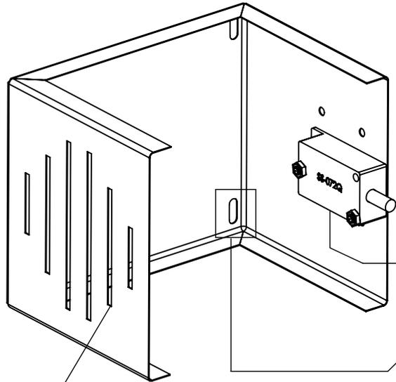
**Orificios para Switch:** Configuración de tamper switch con variedad de perforaciones para modelos SF-TAMP-01/SS-072Q (No incluidos).
