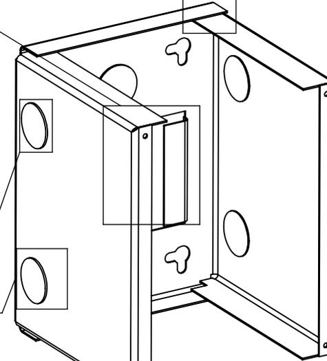
Perforación para ajuste de cubierta a cuerpo x4
