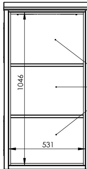
1. Fabricado en lámina de acero galvanizado calibre 11, 14 18, 20.
