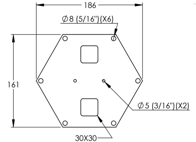
1. Fabricado en lámina de acero calibre 16 galvanizado.
