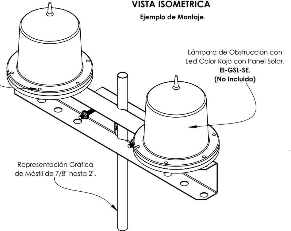
1. Fabricado en lámina de acero calibre 16 galvanizado.
