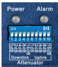
Los amplificadores bidireccionales cuentan con 2 LEDs indicadores para supervisión y mantenimiento. Al energizar el equipo, el LED POWER se ilumina verde, así como el LED ALARMA durante un funcionamiento normal, tornándose éste a naranja si la señal de entrada es demasiada o rojo si existe auto-oscilación, que es causada generalmente por una corta separación entre antenas interna-externa.
