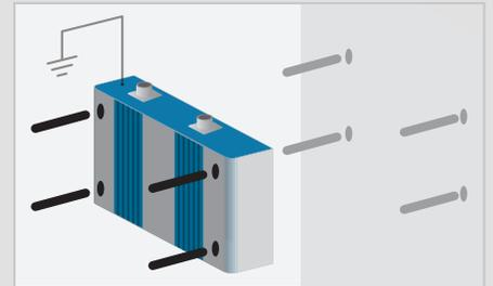
3. La fuente de alimentación debe instalarse en un lugar de fácil acceso, de acuerdo a las normas de seguridad y desconectarse cada vez que se de mantenimiento al equipo.
