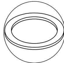
Ranuras para pasar cables de  $\varnothing 35$  y  $\varnothing 45$  (X2).
